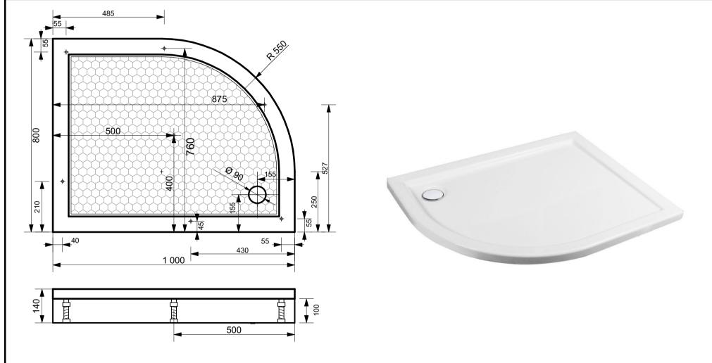
ПРОИЗВОДСТВО ИЗДЕЛИЙ ИЗ ЛИТЬЕВОГО МРАМОРА Допустимое отклонение линейных размеров ± 5 мм
